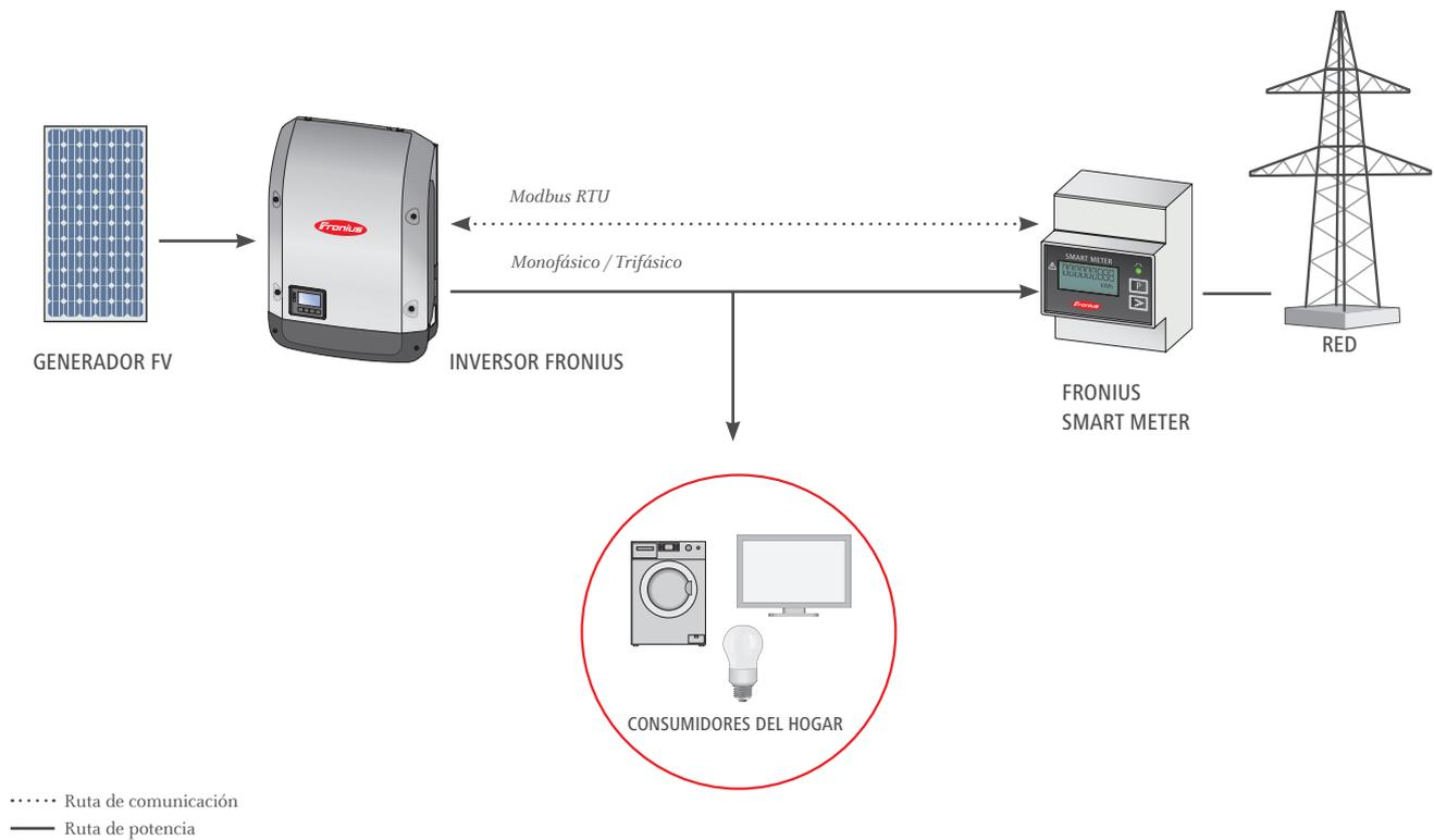
El Fronius Smart Meter es compatible con todos los inversores con un Interface RS485 (Modbus RTU). El Fronius Smart Meter funciona en paralelo con el Datamanager 2.0 para los inversores Fronius IG Plus. El Fronius Smart Meter puede ser instalado en cualquier momento junto con el Fronius Datamanager 2.0, después de la puesta en marcha de un inversor.
